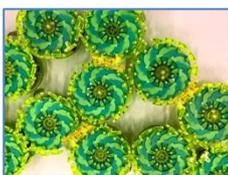
Des chercheurs américains se sont inspirés des cellules humaines pour créer un système de robots collaboratifs. En forme de disque et aimantés les uns aux autres, ces robots peuvent ensemble se déplacer et transporter des objets. Ici, avec une multitude de "cellules universelles", les chercheurs obtiennent un système robotique capable de réaliser différentes formes, différents mouvements et différentes missions. De quoi attester qu'une robotique simple mais puissante et fiable est possible.
