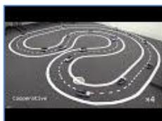
Il est coûteux de tester des algorithmes de conduite pour voitures autonomes sur la route. Une équipe britannique a donc fait ses tests en laboratoire à l'aide de véhicules miniatures et observé ce qui se passe quand les voitures communiquent ou non. Grâce à cette installation, les chercheurs montrent l'importance de la coopération entre les futures voitures autonomes pour obtenir un trafic fluide.
