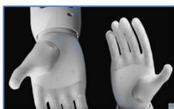
Le robot « BionicSoftHand » est pneumatique, ce qui signifie qu'il fonctionne largement grâce à l'air comprimé. La peau extérieure est douce et imite la chair humaine, tandis que les chambres remplies d'air qui composent les doigts lui permettent de saisir et de manipuler les objets de la même manière qu'une main humaine.
