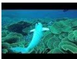
Une équipe du MIT a développé un robot flexible en forme de poisson. Muni d'une caméra et contrôlé à distance grâce à un système de communication acoustique, il peut descendre jusqu'à 18 mètres de profondeur pour observer la faune marine. Il s'appelle SoFi pour "Soft Robotic Fish".
