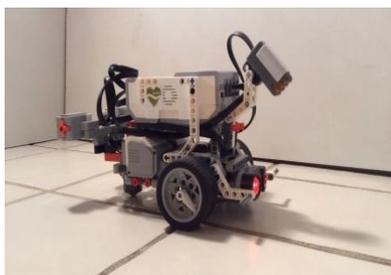
Le collectif OpenWorm a cartographié toutes les connexions neuronales d'un ver pour simuler son cerveau dans un programme informatique. Le robot bouge, s'arrête quand il rencontre un obstacle, et même recule grâce à un réseau de connexions imitant un cerveau. S'ils en sont encore très loin, les scientifiques espèrent à terme pouvoir reproduire ce processus avec des animaux plus complexes, puis avec un cerveau humain.
